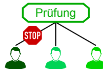
Abb. 3.15: Statischer Rollen-Cardinality-Constraint: Die Zuordnung eines dritten Benutzers zur Rolle „Prüfung“ ist nicht erlaubt.
