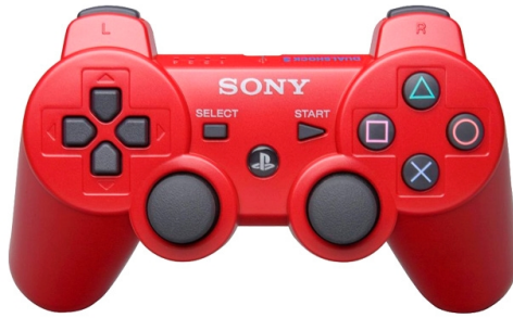
Rysunek 8.12: Kontroler Sony DualShock 3 wykorzystywany do sterowania manipulatorem
