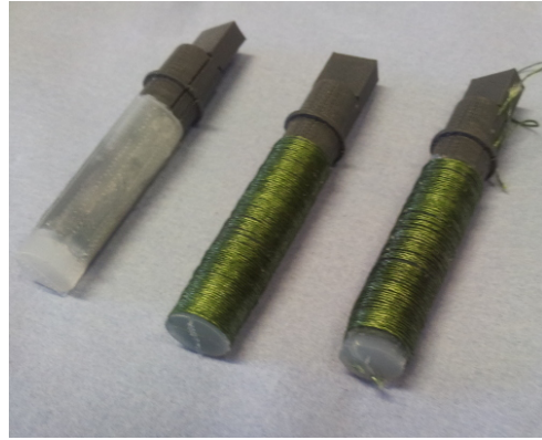
(b) Cylindry po nałożeniu zbrojenia.
