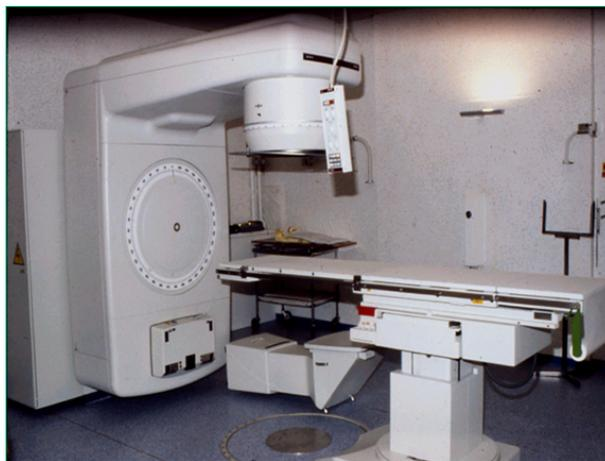
FIG. 1.1 – Accélérateur linéaire de photon utilisé en radiothérapie
