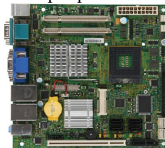
Fig.15. The MSI IM-GM45 Mini-ITX mainboard
