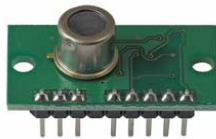
Fig.7. TPA81 IR thermal sensor
